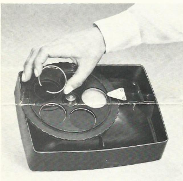
Auswechseln der Filter: Dazu müssen die Opalscheibe an der Frontseite sowie der schwarze Rahmen mit montiertem Filterrad abgenommen werden.
