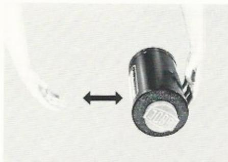
Respecter les temps prescrits par les fabricants de produits chimiques, les 10 dernières secondes devant être réservées au vidage du tambour et à son nouveau remplissage. La longueur de roulement doit être d'au moins 50 cm, ce qui correspond environ à un tour de tambour. Une rotation alternée, durant jusqu'à 2 secondes, selon un rythme régulier, pendant toute la durée du développement, garantit l'obtention de résultats constants.
