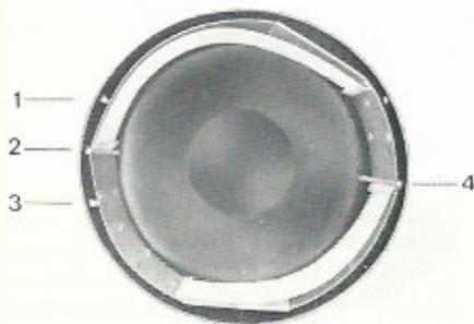
Toujours introduire les planfilms ou les papiers, face émulsionnée orientée vers le haut. Amener les coulisseaux du porte-format sur le bord du film ou du papier, puis plier le porte-format pour que le matériel photosensible demeure coincé; ensuite, glisser le porte-format entre les tiges de guidage du tambour. La matière plastique transparente facilite la seconde insolation.
